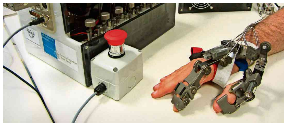
Eine Hand-Exoprothese soll Schlaganfallpatienten helfen. Foto: Uniklinik Tübingen/Vitiello
